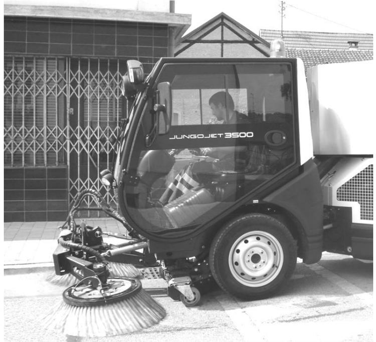
Compact et maniable, le véhicule permet de traiter des endroits difficilement accessibles, grâce à son rayon de braquage de 1,90 m. Equipé de quatre roues motrices, il est homologué pour circuler à 40 km/h et se conduit avec un permis simple. En phase de travail, il évolue à une vitesse de 25 km/h, et son châssis rigide lui assure une grande stabilité. Doté d'un moteur diesel d'une puissance de 38 KW, l'engin consomme environ 5 litres à l'heure, en situation d'utilisation moyenne.
