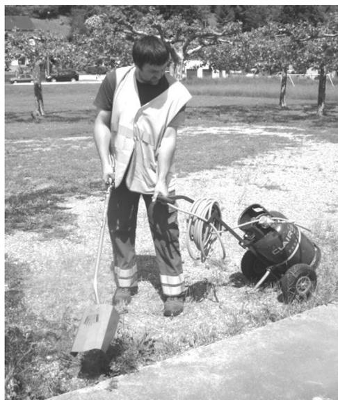
Cet appareil thermique, avec capot de protection, support de bras et régleur d'intensité, est alimenté par une bouteille de gaz propane déposée sur un chariot à tracter.
